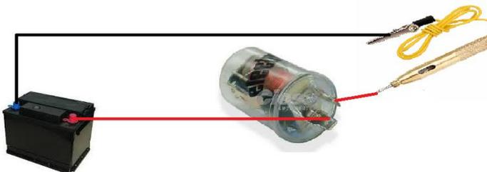
NOTA: para la revisión de FLASHER 2 TERMINALES es necesario conectar el flasher en serie en el polo positivo, la lámpara debe encender y apagar automáticamente
